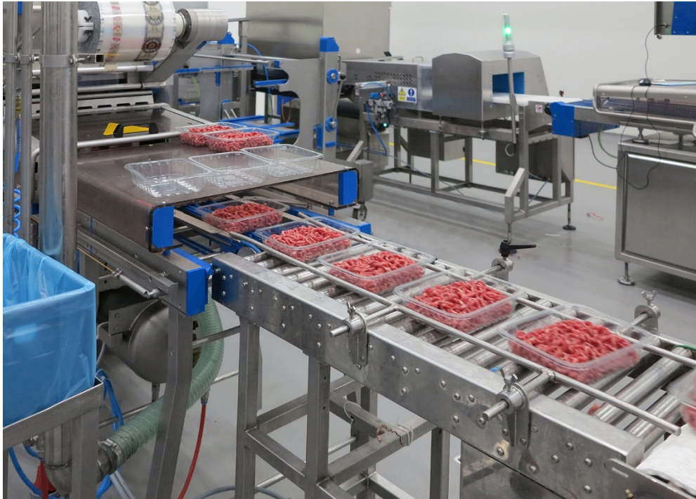
Figuur 4: Het industrieel vacuüm verpakken van gehakt in een thermoforming-verpakkingsmachine
