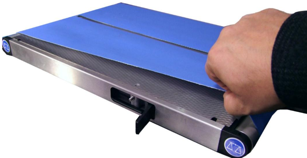
Transportbandconstructie. Door het nieuwe ontwerp kunnen de transportbanden en zelfs de hele transportbandconstructie zonder gereedschap snel en eenvoudig gewisseld worden.
